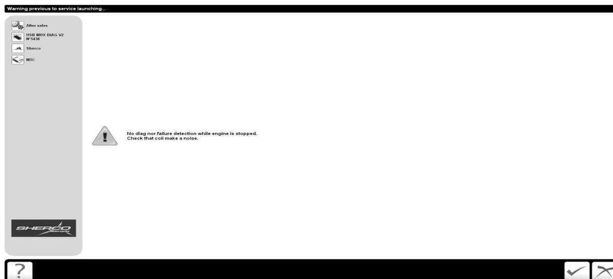
Le système n'est pas capable de détecter un défaut bobine moteur à l'arrêt. Que la bobine soit défectueuse ou non, le résultat du test sera identique. Il faut donc lors du test vérifier que la bobine émette un son caractéristique d'un bon fonctionnement
